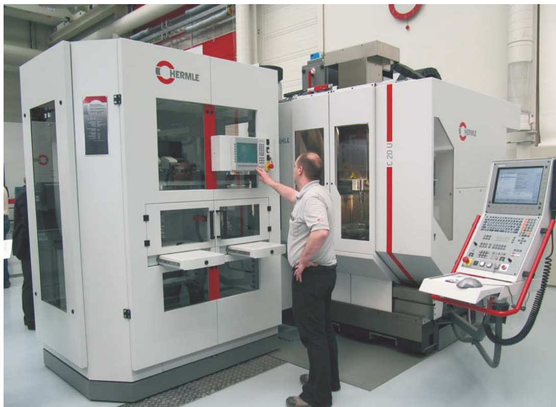
Een kleine palletwisselaar van Hermle die naar behoefte handmatig voor of naast het bewerkingst centrum geschoven kan worden. De toegankelijkheid van de machine bij handmatig werk blijft op die manier gewaarborgd (foto: Reinold Tomberg)
