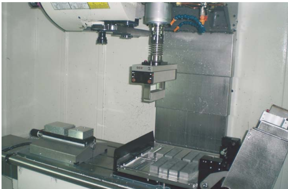
Het Nederlandse bedrijf Teqq heeft voor drie-assige, verticale freescentra een automatiseringsoplossing ontwikkeld waarbij een gripper in de hoofdspil de werkstukken haalt uit een magazijn en positioneert in de machineklem (foto: Reinold Tomberg)
