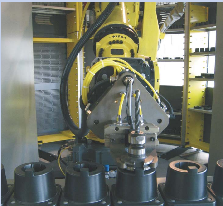
Een robot in een cel van Cellro bezig met de handling van verspanende gereedschappen. Bij automatisering moet de bewaking van gereedschappen naar een hoger niveau (foto: Reinold Tomberg)
