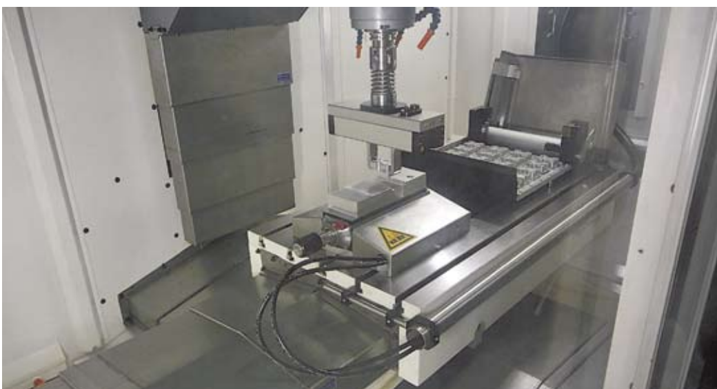
Het systeem integreert als een accessoire voor de freesbank en bestaat uit vier modules, die samenwerken: een adapter en gripper, een hydraulische klem, een productmagazijn en een control-unit.
