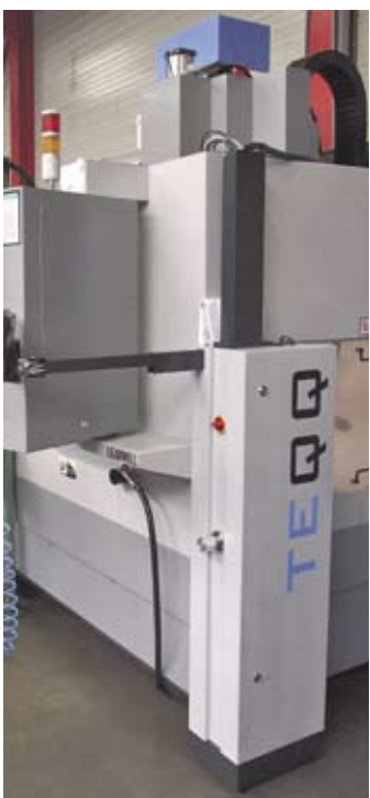
De automatiseringsoplossing van TEQQ is niet meer dan een slanke module, die stijf tegen de machine is geplaatst. De rest van het systeem bevindt zich in de machine.
